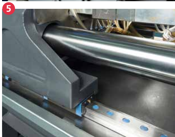
图片① 定制特种钢拉杆，强化安全设计，满足超高周期使用。
