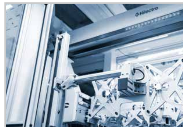
XTS系列侧取贴标 集成周边输送线 生产案例：奶茶杯侧取贴标 生产要求：1出8
