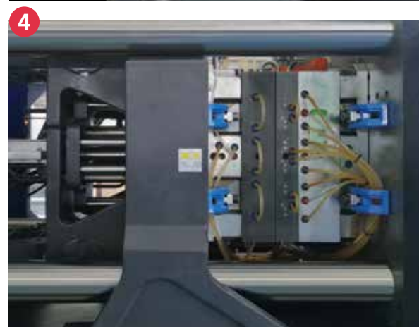
图片① 定制特种钢拉杆，强化安全设计，满足超高周期使用。
