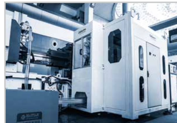
XTS系列侧取叠模贴标 集成周边输送线 生产案例：保鲜盒侧取叠模贴标 生产要求：2盒+2盖
