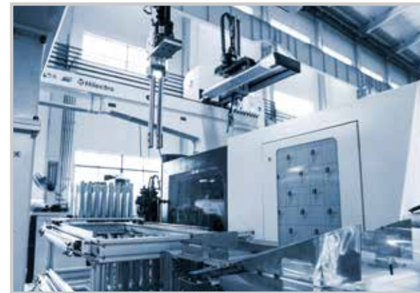
XTA系列高速伺服机械手 集成周边辅机自动化 生产案例：刀叉勺取件打包自动化 生产要求：1出16，50pc自动封装
